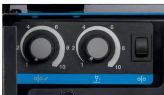
**La vitesse fil avant amorçage (run-in) ajustable et le réglage du rétreint (burn-back)** permet à l'opérateur d'optimiser les réglages des paramètres d'amorçage et d'arrêt de l'arc – Pour un amorçage parfait et instantané et éviter le collage du fil en fin de cycle.
